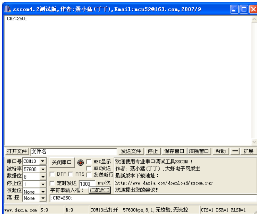
图 6-2-2 设置 CAN 波特率参数
