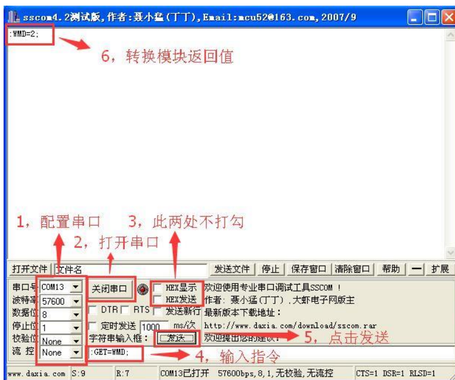
图 6-2-1 读取转换模块工作模式参数
